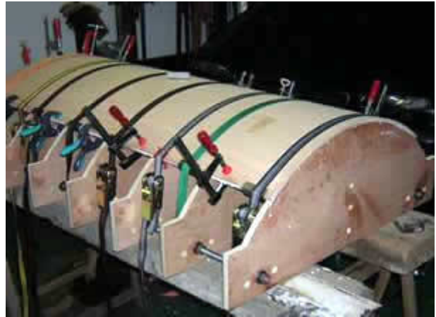
Cintrage sur la forme
